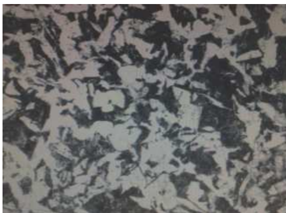
Рис. 6. Феррито-перлитная структура, \times 200
