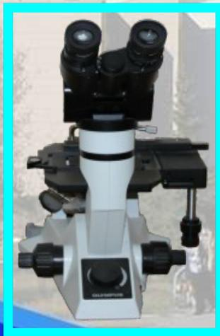
Предназначены для исследования фазового состава и структурных особенностей металлов и сплавов при увеличении до  $\times 1000$  раз (от  $\times 100$ ). LEICA DM IRM HC оснащен приставкой для определения микротвердости отдельных фаз, приставкой для автоматической микрофотосъемки микроструктуры. Для учебных целей оснащен цветной видеосистемой SONY и телевизионным экраном, на который проецируется изображение с микроскопа.
