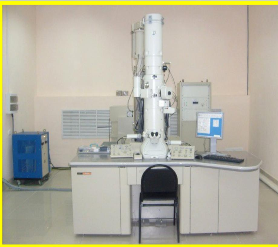
Микроскоп предназначен для изучения атомно-кристаллической структуры материалов, включая морфологию и характеристики кристаллической структуры, характеристики типа и распределения разных дефектов кристаллического строения (границы зерен, дефекты упаковки, дислокации, разные комбинации точечных дефектов), а также проводить качественный анализ выделяющихся в сплавах частиц и разных включений, исследования доменной структуры. Увеличение микроскопа от 50 до 1500000 крат. Разрешение до 2 Ангстрем.
